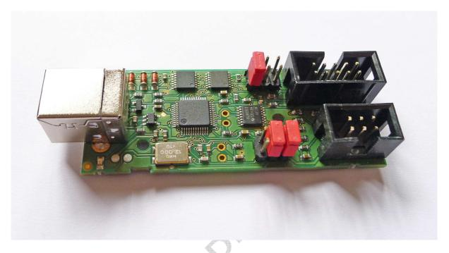
Spannungsversorgung des Mikrocontrollerboards über den Programmieradapter Laut Handbuch kann der Programmieradapter Schaltungen mit einem Strombedarf von bis zu 50mA versorgen. In der Praxis sind auch etwas höhere Ströme problemlos möglich (bis ca. 80mA). Sobald eine Schaltung einen zu hohen Strom benötigt, stürzt der Programmieradapter beim Anschluss an die ISP/PDI Schnittstelle ab und muss zum Neustart kurz vom USB Bus getrennt werden (man erkennt dies am Status der LED links unten).
