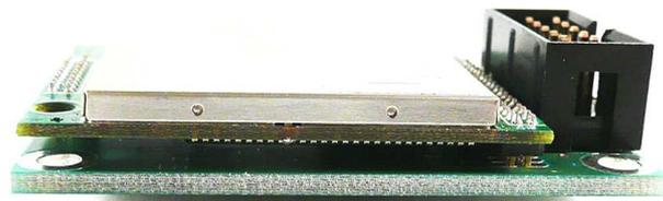
**Kontrollieren Sie den korrekten Sitz der Stecker. Ein um einen Pin verschobener Stecker führt nach Anschluss der Versorgungsspannung zur Zerstörung des Moduls!**
