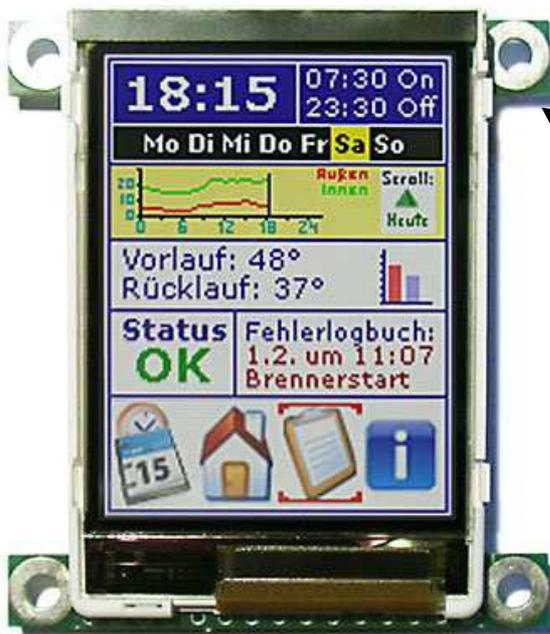
Die vier Stück Montage-„Ohren“ können aufgrund der Vorperforation einfach abgebrochen werden.
