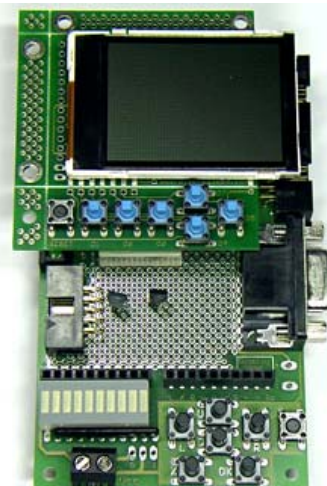
3. Modul aufstecken Fertig. Schaltungsänderungen? Einfach das Modul abziehen - das Hauptmodul bleibt wie neu.
